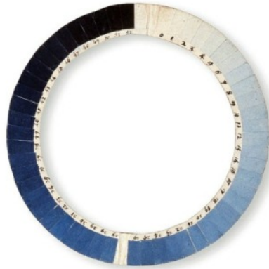
Matériel de recherche, Horace-Bénédict de Saussure deuxième schéma du cyanomètre, 1788 Collection Musée d'histoire des sciences, Geneva
